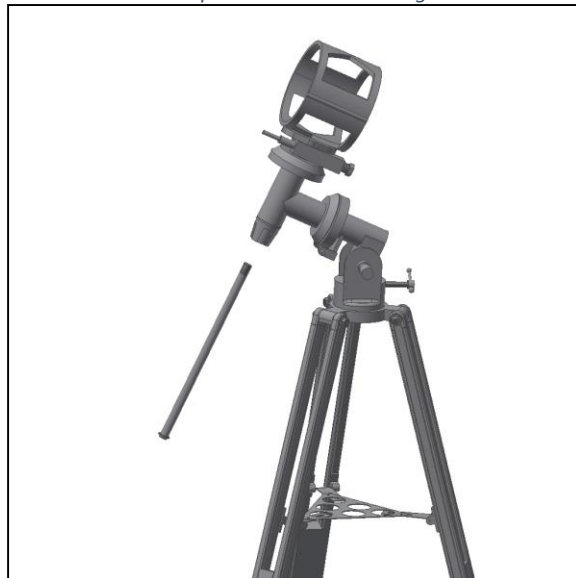
Abb. 6. Abringung der Gegengewichtsstange.
